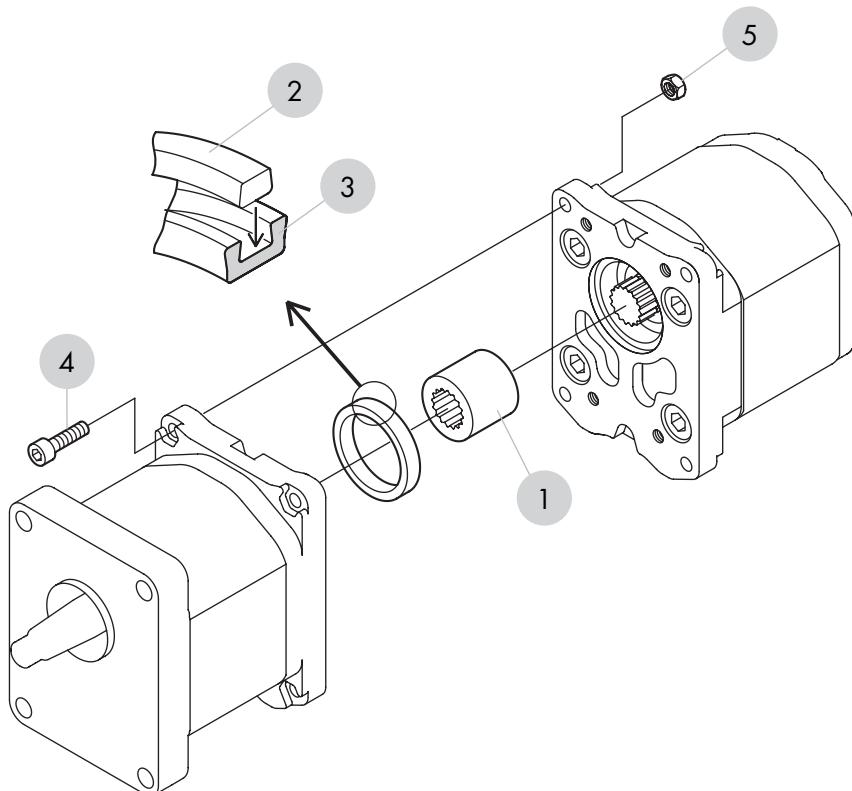
COMPONENTI BASE DEL KIT DI ASSEMBLAGGIO
