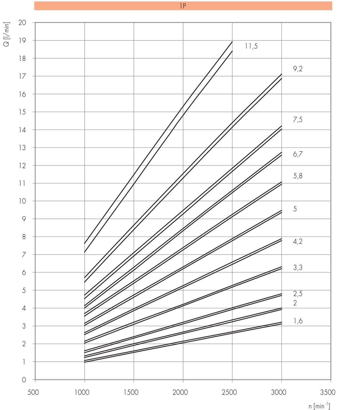
Le curve sono state ottenute alla temperatura di 50°C, utilizzando olio con viscosità 30 cSt alle pressioni sotto riportate.
